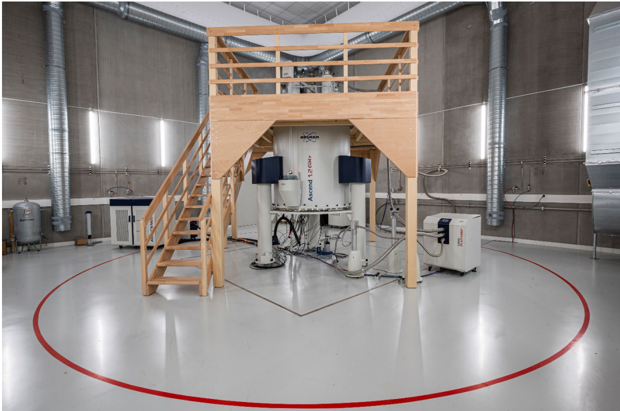
Spectromètre RMN 1200 MHz © Alexandre CAFFIAUX – Université de Lille
